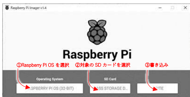
図 1 マイクロ SD カードに Raspberry Pi OS を書き込む Raspberry Pi Imager を起動し、①Raspberry Pi OS を選択し、②対象のマイクロ SD を選択し、③書き込みボタンをクリックする
